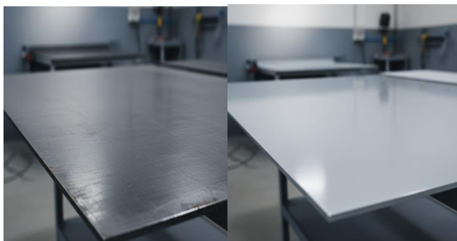
Рис.2. Преди и след студено поцинковане
