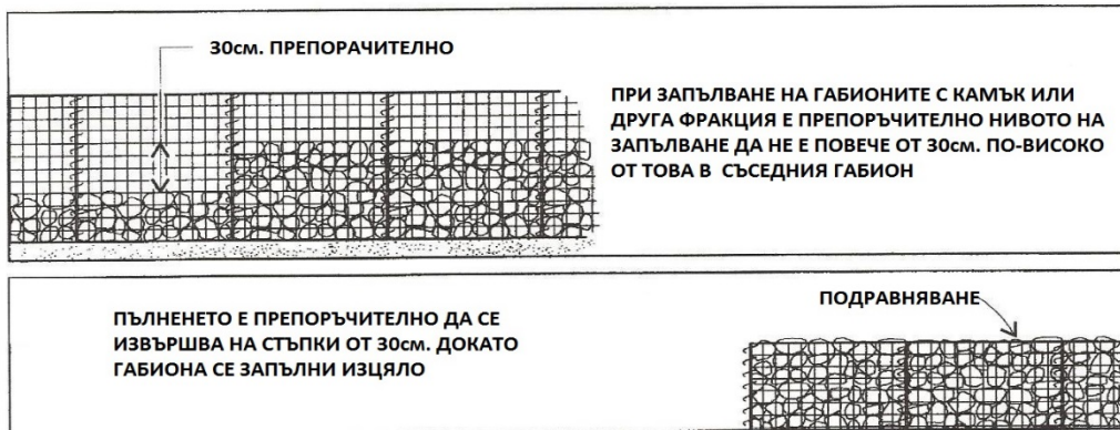
Фигура 5. Запълване и затваряне на габион
